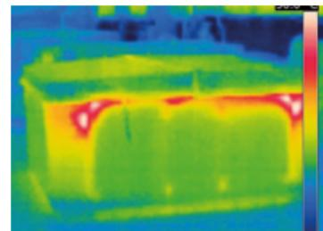
Mit dem EcoSpa-System durchgeführter Wärmedichtigkeitstest
